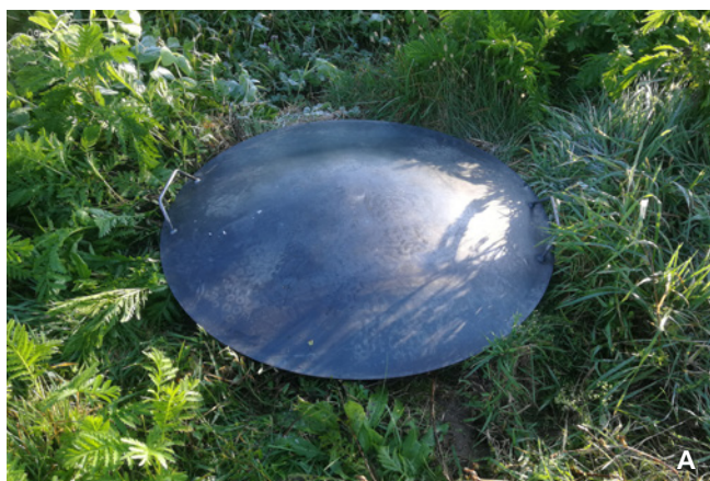
Fig. 1 Progettazione del modello HAFL di una copertura metallica per pozzetti di ingresso aperti al fine di impedire l'ingresso di prodotti fitosanitari nei corpi idrici durante i trattamenti. (A) La copertura metallica supera il bordo del pozzetto, assicurandone una protezione ottimale sul campo. (B) I perni metallici garantiscono un buon ancoraggio del coperchio e una distanza sufficiente dal terreno. (Fonte: HAFL).
