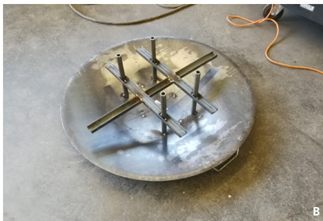
Fig. 1 Progettazione del modello HAFL di una copertura metallica per pozzetti di ingresso aperti al fine di impedire l'ingresso di prodotti fitosanitari nei corpi idrici durante i trattamenti. (A) La copertura metallica supera il bordo del pozzetto, assicurandone una protezione ottimale sul campo. (B) I perni metallici garantiscono un buon ancoraggio del coperchio e una distanza sufficiente dal terreno. (Fonte: HAFL).
