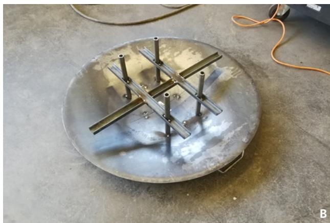
Fig. 1 Modèle de la HAFL d'un couvercle métallique pour les regards ouverts afin d'éviter le déversement de PPP dans les eaux par la dérive. (A) Un dépassement du bord du couvercle métallique pour les couvercles de regards garantit une protection optimale sur le terrain. (B) Des tiges métalliques assurent un bon ancrage et une distance suffisante par rapport au sol. (Source: HAFL).
