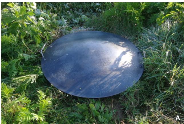
Abb. 1 Modell-Entwurf der HAFL einer Metallabdeckung für offene Einlaufschächte zum Schutz vor Einträgen von Pflanzenschutzmittel in Gewässer durch Abdrift während des Applikationsvorgangs. (A) Ein Überlagern des Metalldeckelrands bei den Schachtdeckeln gewährleistet einen optimalen Schutz im Feld. (B) Metallstifte sorgen für eine gute Verankerung und einen ausreichenden Abstand zum Boden. (Quelle: HAFL).
