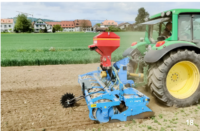
Ansaat von Hand oder mit Sämaschine Typ Krummenacher empfohlen. Nach der Saat unbedingt mit Voll- oder Rauwalze walzen.
