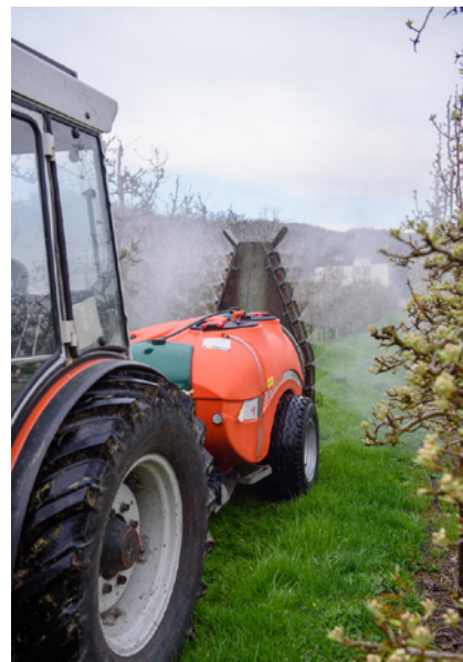
La contaminazione con PF all'esterno dell'irroratrice può essere considerevole, specialmente con irroratrici ad aeroconvezione, D. Dietiker.
