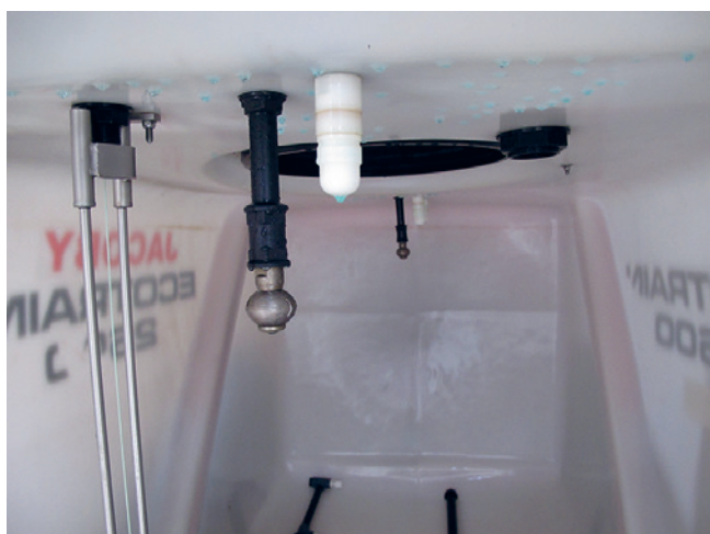
Serbatoio di un'irroratrice con ugello di pulizia interno, agrotop.
