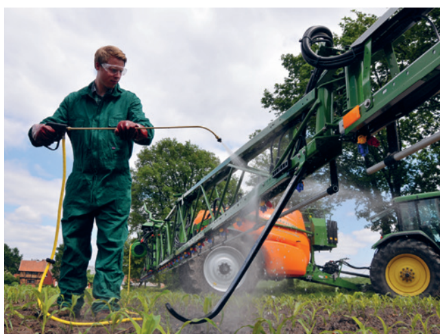
Pulizia esterna di un'irroratrice con una lancia su un'area inerbita, G. Höner.
