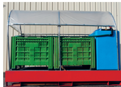
Les systèmes de traitement biologiques permettent la dégradation des résidus de PPh par des microorganismes, CCD SA.
