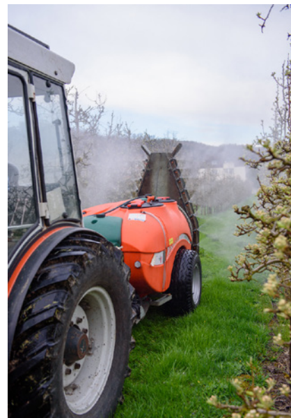
Des contaminations avec des PPh à l'extérieur du pulvérisateur peuvent être particulièrement importantes sur les appareils à jet porté, D. Dietiker.
