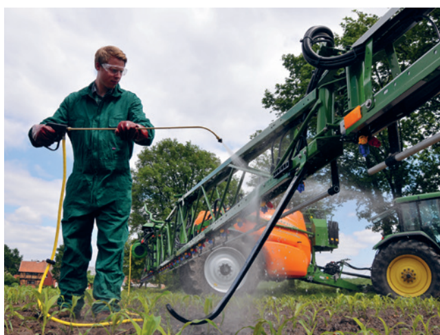
Rinçage extérieur d'une rampe de traitement avec une lance de rinçage sur une surface couverte de végétation, G. Höner.
