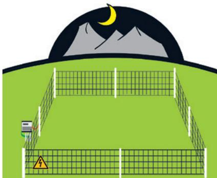
**Vorteile:** Der rechteckige Zaun sollte mit zusätzlichen Eckpfosten aufgestellt werden, diese nehmen die Zugkräfte auf und der Zaun kann optimal gespannt werden.
