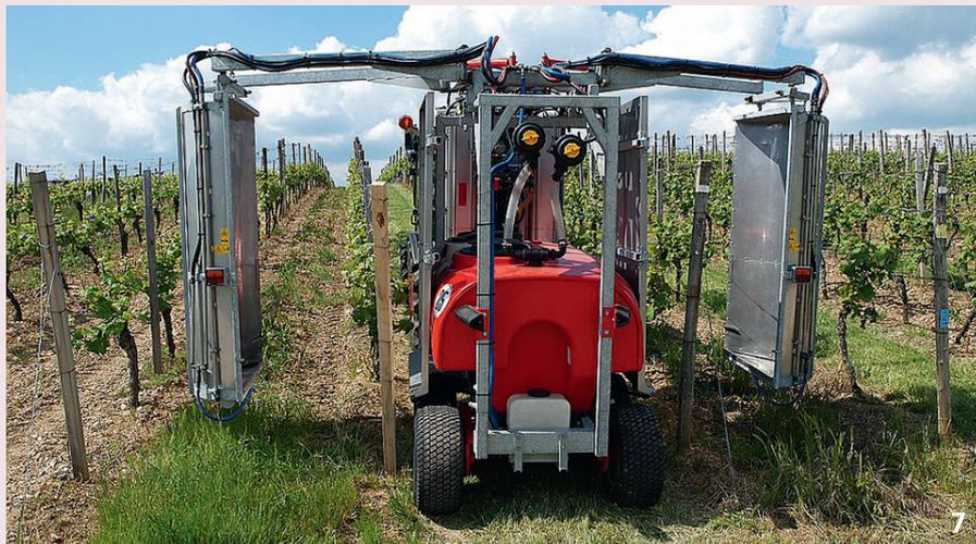
Irroratrice dotata di sistema di riciclo per una perdita minima di prodotti fitosanitari
