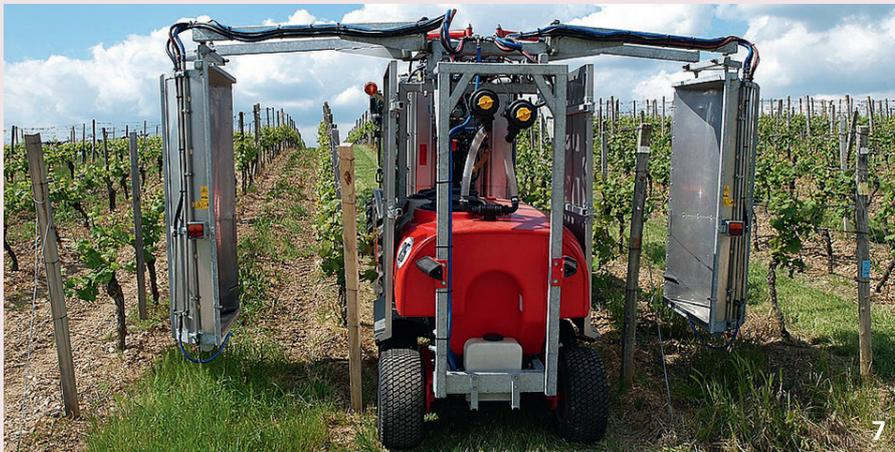
Minimaler Brühverlust mit dem Recyclingsprühgerät
