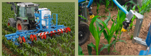
Figure 2 : Système de pulvérisation localisée sur le rang couplé à un binage sur l'interrang
