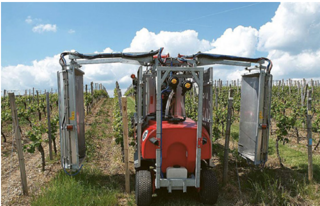
Tunnelrecycling-Sprühgerät; Quelle: Hans Wanner GmbH
