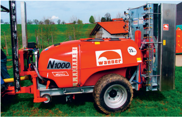
Spritzgerät mit Vegetationsdetektor; Quelle: Hans Wanner GmbH
