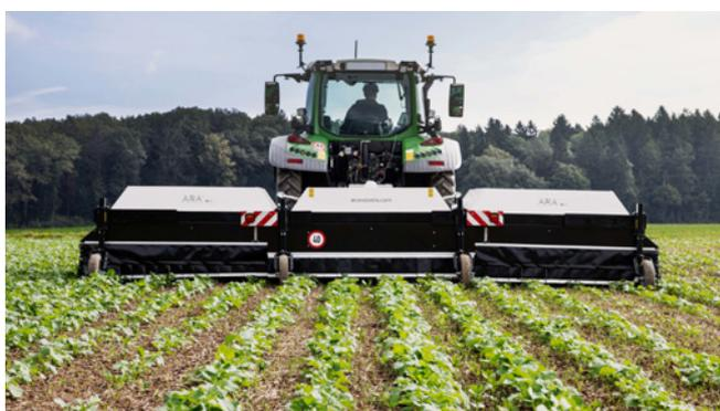
Irroratrice per il trattamento pianta per pianta con riconoscimento tramite telecamere e schermatura completa; fonte: ecorobotix
