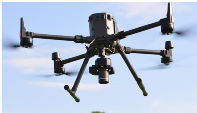
*Drone con telecamera per la mappatura delle malerbe;
