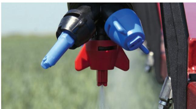
Mehrfachdüsenträger zum schnellen Düsenwechsel;
