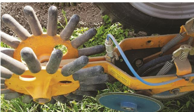
An die Sämaschine gekoppelte Bandspritzung; Quelle: SFZ
