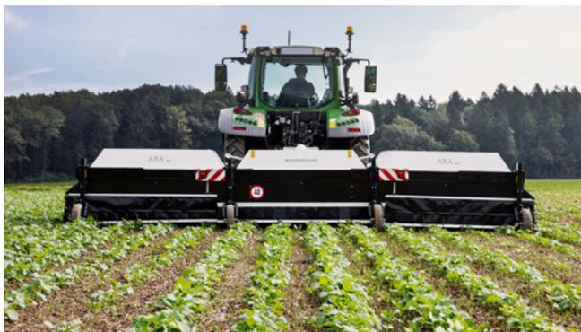
Diese Massnahme ist mit Geräten möglich, die neben der kameragestützten Applikation den Bereich auch Abschirmen. Die Abschirmung erleichtert der Kamera die Erkennung, verringert aber ebenso die Abdrift.
