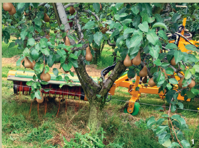
L'impiego di erbicidi può essere ridotto grazie all'uso di una spollonatrice.
