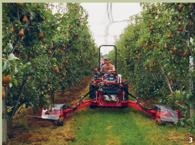
Le travail du sol avec une bineuse pour détruire les adventices nécessite plusieurs passages et doit se faire seulement dans de bonnes conditions.
