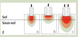
La figure ci-contre montre les effets de deux charges par roue (une flèche: charge simple; deux flèches: charge double) et de deux largeurs de pneus.
