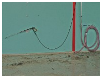
Figura 5: lancia di lavaggio ad alta pressione (AGRIDEA).
