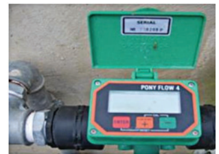
Photo 4 : compteur volumétrique électronique (G. Fiaux, 2007)
