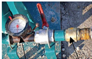
Photo 3 : compteur volumétrique mécanique avec clapet anti-retour (G. Fiaux, 2007).
