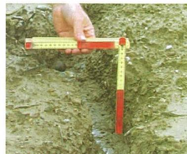
Mesure d'une rigole.
